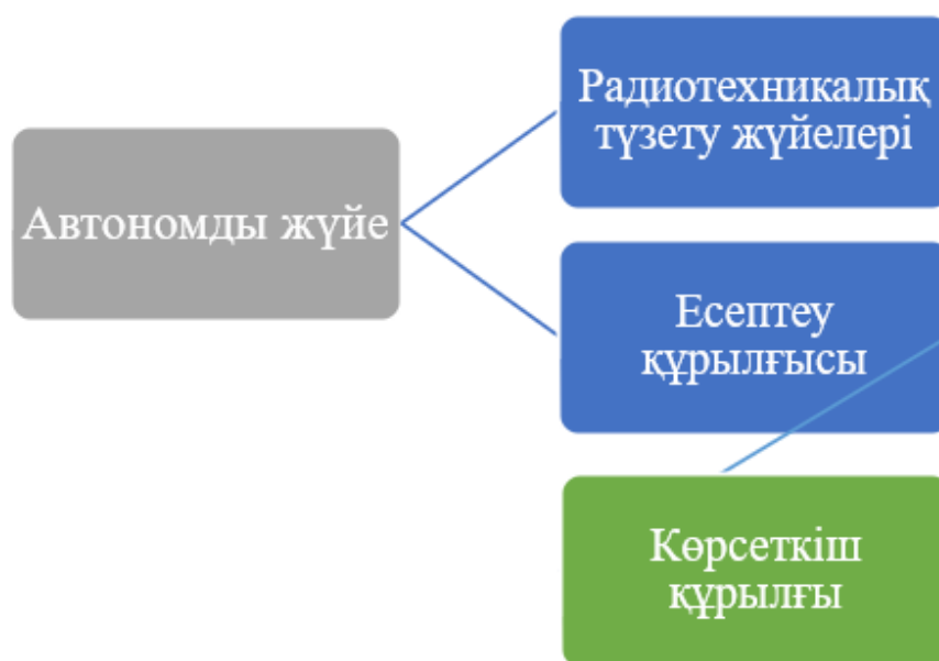
1.2-сурет – ПНО навигациялық жүйесінің жалпыланған құрылымдық схемасы
